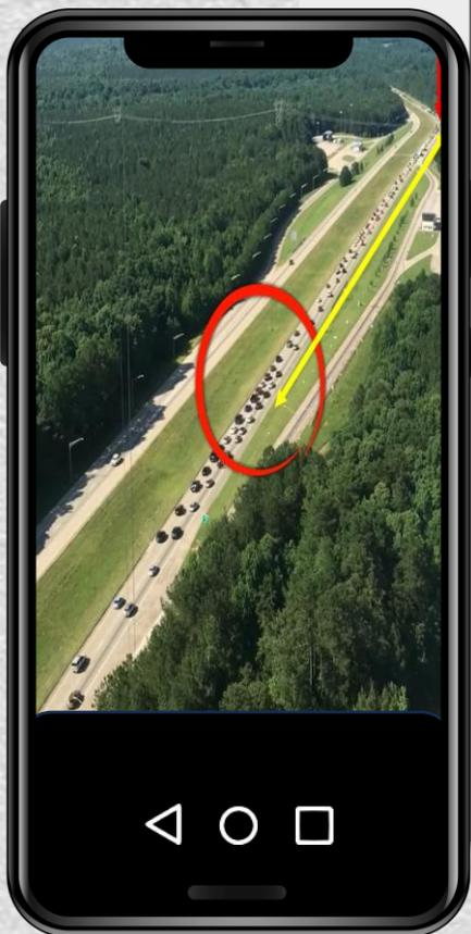
Los **atascos fantasmas** son perturbaciones del tráfico que se originan sin causas aparentes, pues se producen por interferencia de velocidad entre los vehículos cuando hay un elemento distorsionador de la velocidad, como una curva, una pendiente o una ligera frenada de un conductor.
